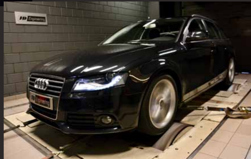
Superflow 4WD-rollebank, onmisbaar voor het ontwikkelen van software
