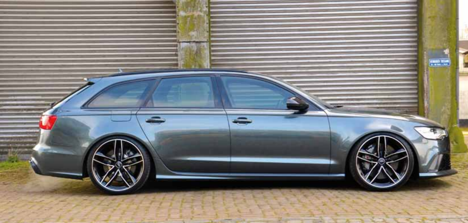
Perfect ogen en perfect liggen vormde het doel bij de ophanging; prima gelukt, met de verlaagde luchtvering, aangepaste demping, sporing en spoorbreedte
