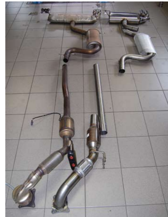
Links de originele downpipe met twee kats, rechts het nieuwe RVS systeem met enkele racekat en rechte middenpijp.
