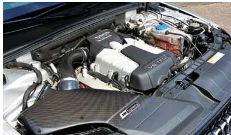
De geblazen V6 levert 522 pk en blijft tot aan 7000 tpm onvermoeibaar vermogen ontwikkelen
