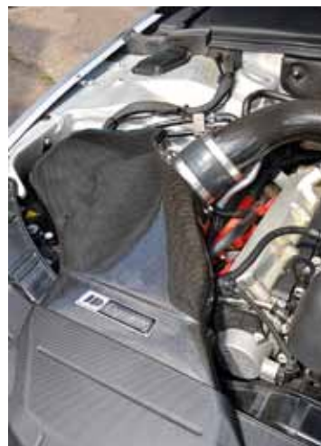
Het ademhalingstraject aan beide kanten verbeterd; aan de inhaalzijde met een carbon airbox en carbon aanzuigbuis
