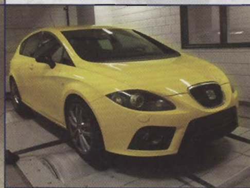
OP DE GLOEDNIEUWE SUPERFLOW ROLLENBANK WORDT GEWERKT AAN EEN TUNINGKIT VOOR DE NIEUWE SEAT LEON CUPRA. DE RESULTATEN KUN JE DIRECT AFLEZEN OP HET GROTE BEELDSCHERM.
