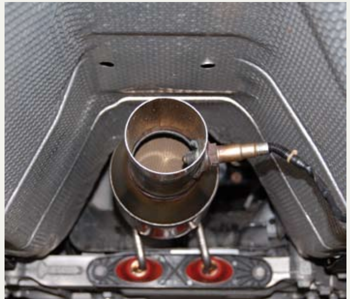
De HJS 200 cpi katalysator minimaliseert tegendruk, waardoor de turbo sneller opspoelt.
