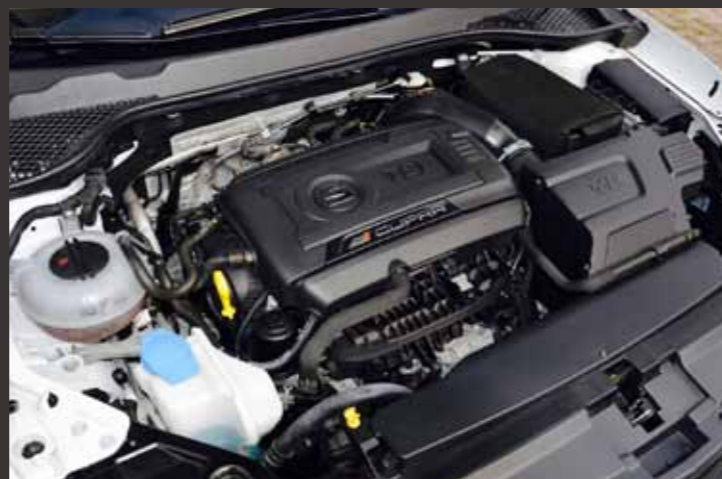
Nieuwe generatie TSI, die pas vanaf Stage 5 een grotere intercooler behoeft
